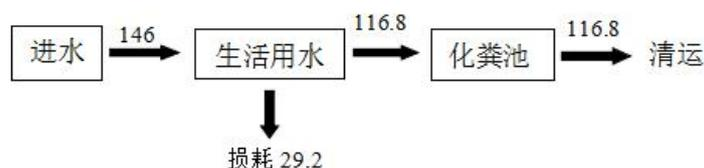
图 2-4 水平衡图 单位 t/a
