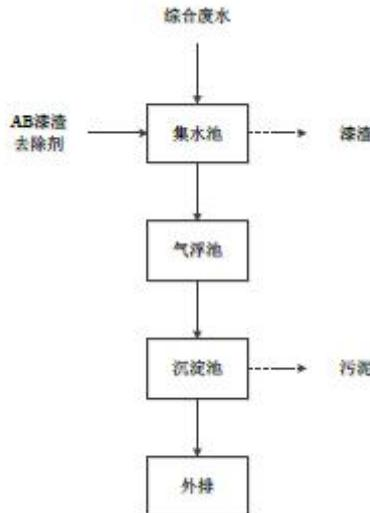
图 3-1 污水处理站工艺流程图
