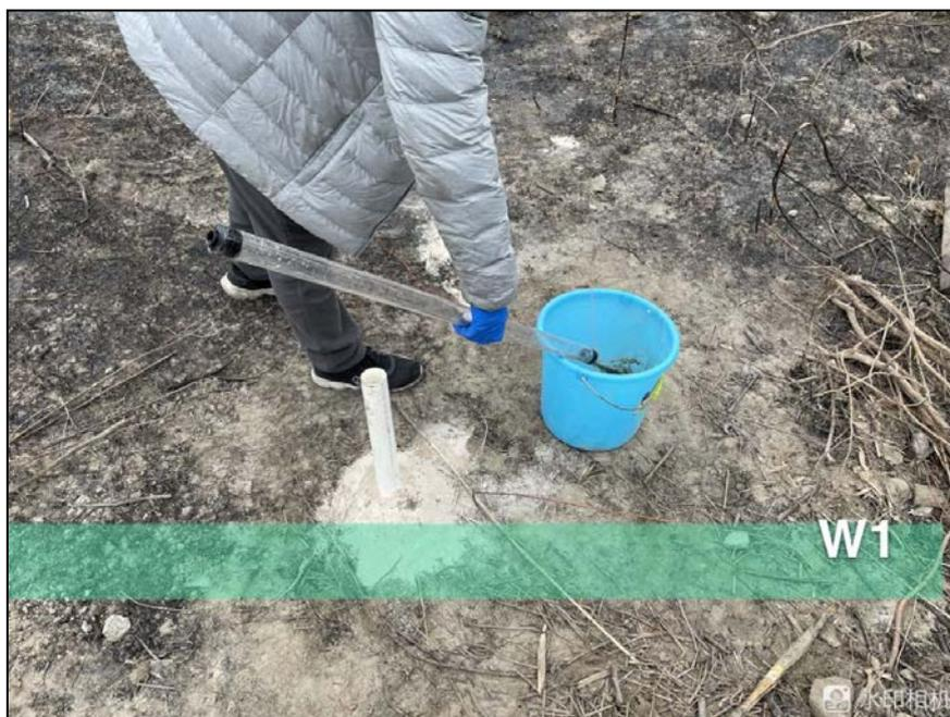
图 5.2-6 建井后洗井现场照片
