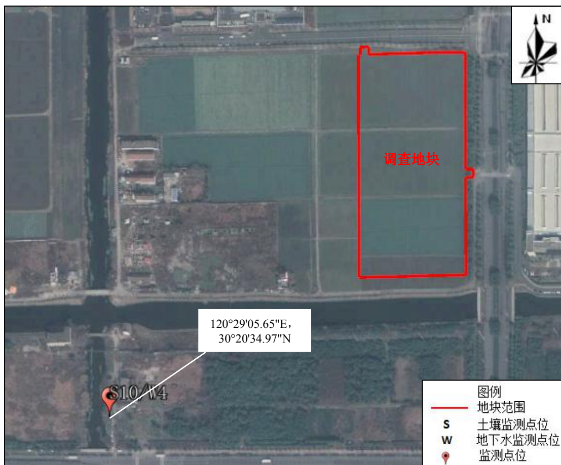
图 4.2-2 本次地块调查土壤及地下水采样点位布置图（地块外，带坐标）
