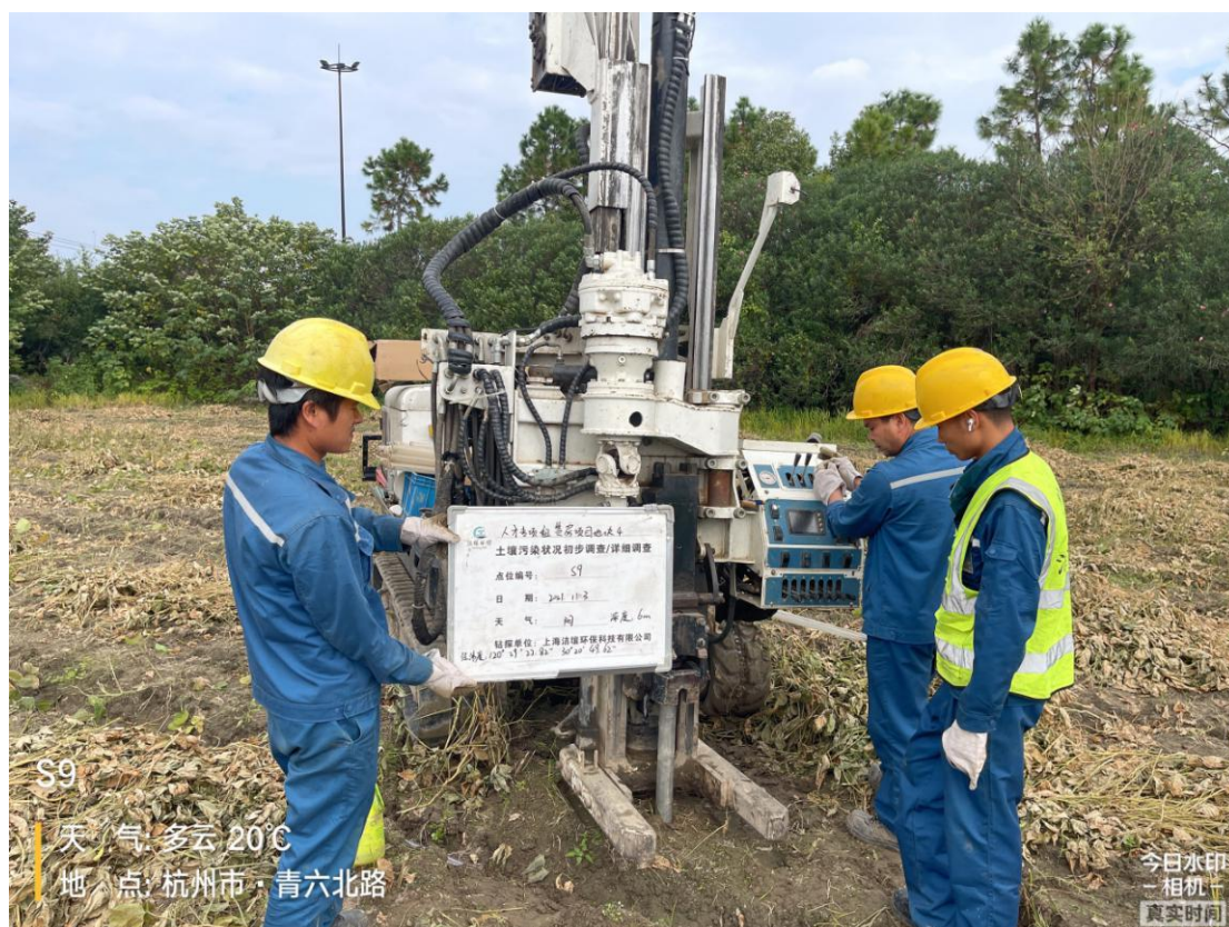
图5.2-1 土壤钻探取样现场照片
