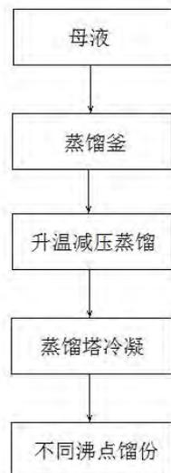
甲酵母液物料由泵经流量计计量、打入蒸馏锅中，由于蒸汽间接加热，溶剂蒸发后气相进入塔中逐层上升至塔顶后进入冷凝器，冷凝后进入回流罐，再由回流泵部分打入塔顶作为回流。由于甲醇沸点较低首先被蒸出，经成品冷凝器冷凝后进入成品暂储罐，再由成品泵打入大成品储罐，母液中其他高沸点溶剂需减压蒸馏，最高温度控制在 160℃，蒸馏锅内残渣趁热排出。系统真空由真空泵来完成，系统热能由水蒸汽供给，冷却水由循环水泵供给。
