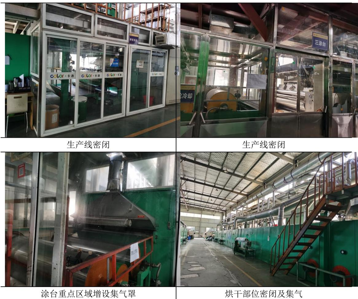
图 4-2-1 溶剂型超细纤维干法线废气收集
