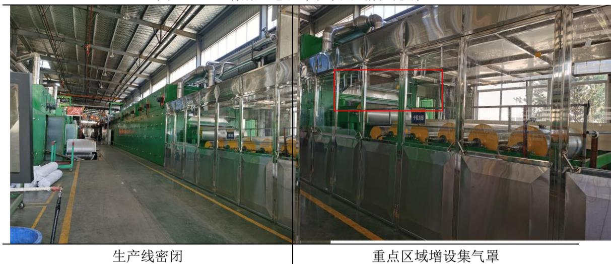
图 4-2-2 无溶剂超细纤维干法线废气收集
