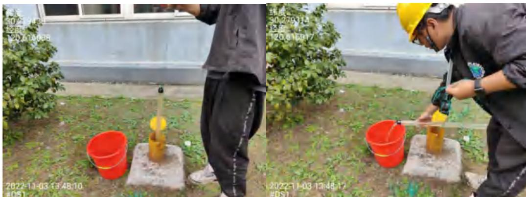
图7.2-1 采样前洗井现场照片
