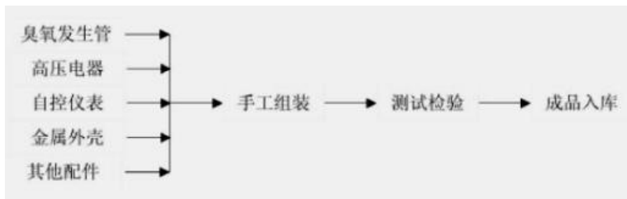
图 4.1-7 臭氧技术处理设备生产工艺流程图
