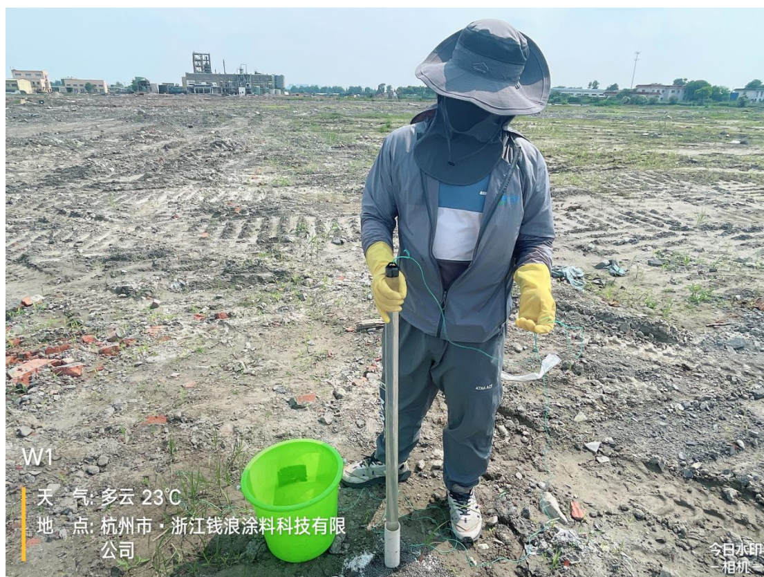
图5.2-7 建井后洗井照片
