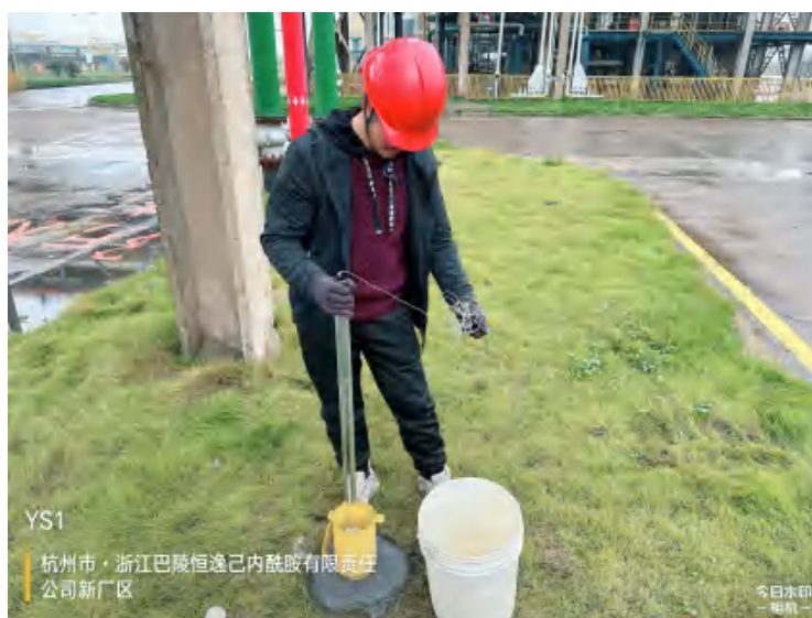
图7.2-4 采样前洗井照片
