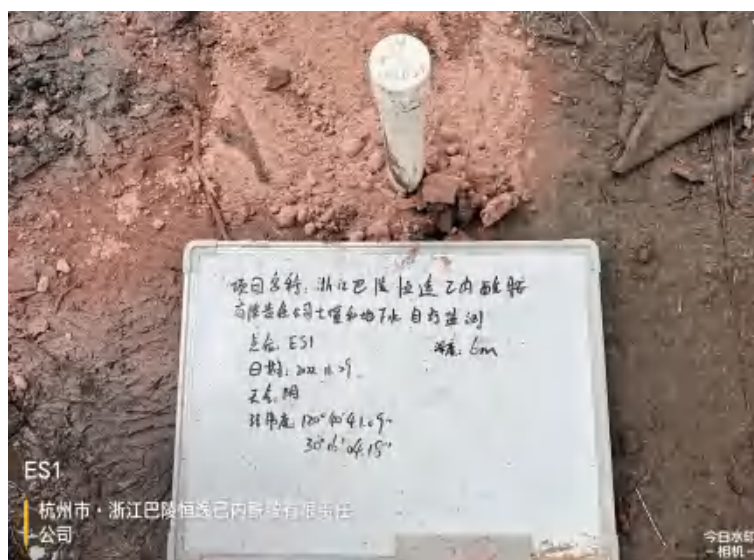
图7.2-3 密封止水及采样井照片
