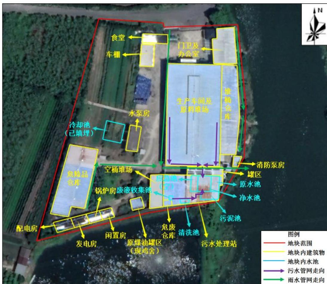
图3.6-4 杭州高扬科技有限公司厂区平面布置图（含雨污管网分布图）
