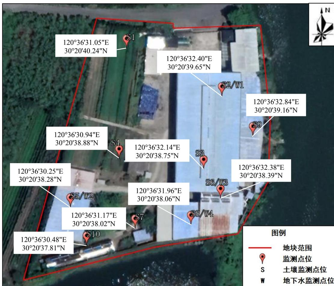
图 4.2-2 本次地块调查采样点位布设图（2021 年地块内历史影像图，带坐标）
