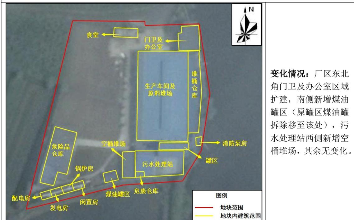
**变化情况：**厂区东北角门卫及办公室区域扩建，南侧新增煤油罐区（原罐区煤油罐拆除移至该处），污水处理站西侧新增空桶堆场，其余无变化。
