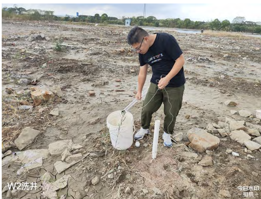
图5.2-7 建井后洗井照片
