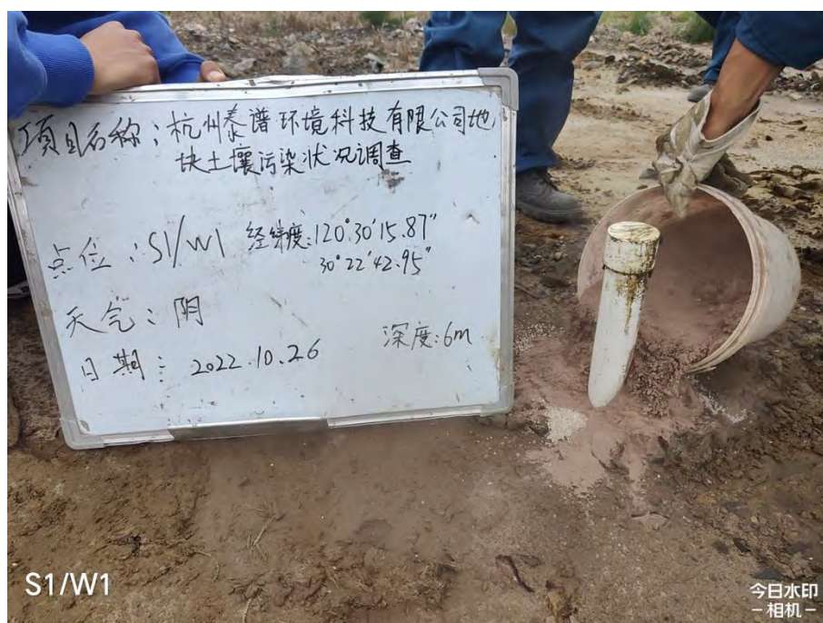
图5.2-6 密封止水及采样井照片
