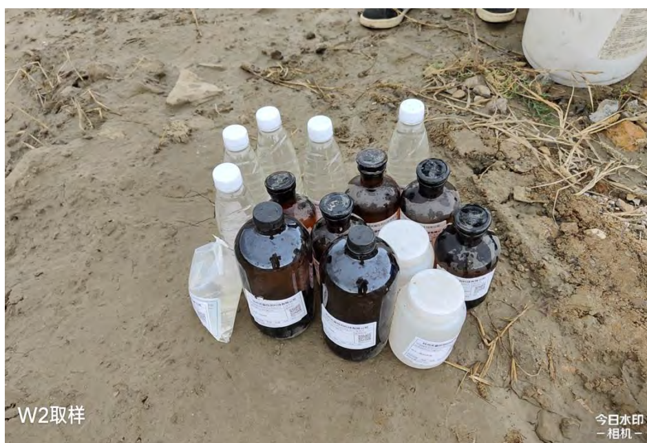
图 5.2-9 地下水分装样品及标签照片
