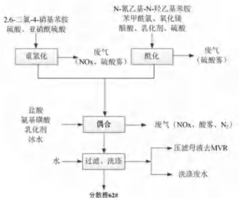
图 3.6-2 分散橙 62#生产工艺流程图
