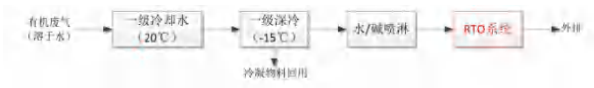
图 4.1-1 有机废气处理工艺流程图
