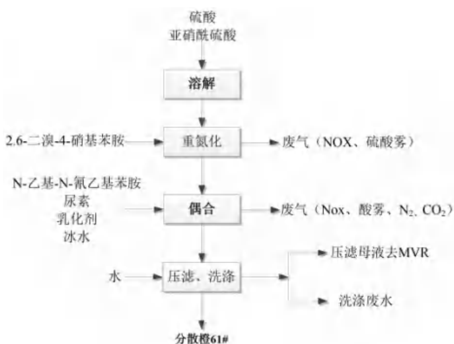
图 3.6-1 分散橙 61#生产工艺流程图
