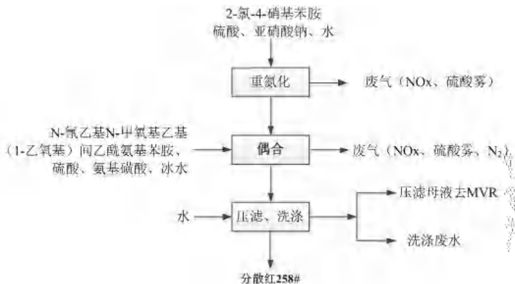
图 3.6-22 分散红 258#生产工艺流程图
