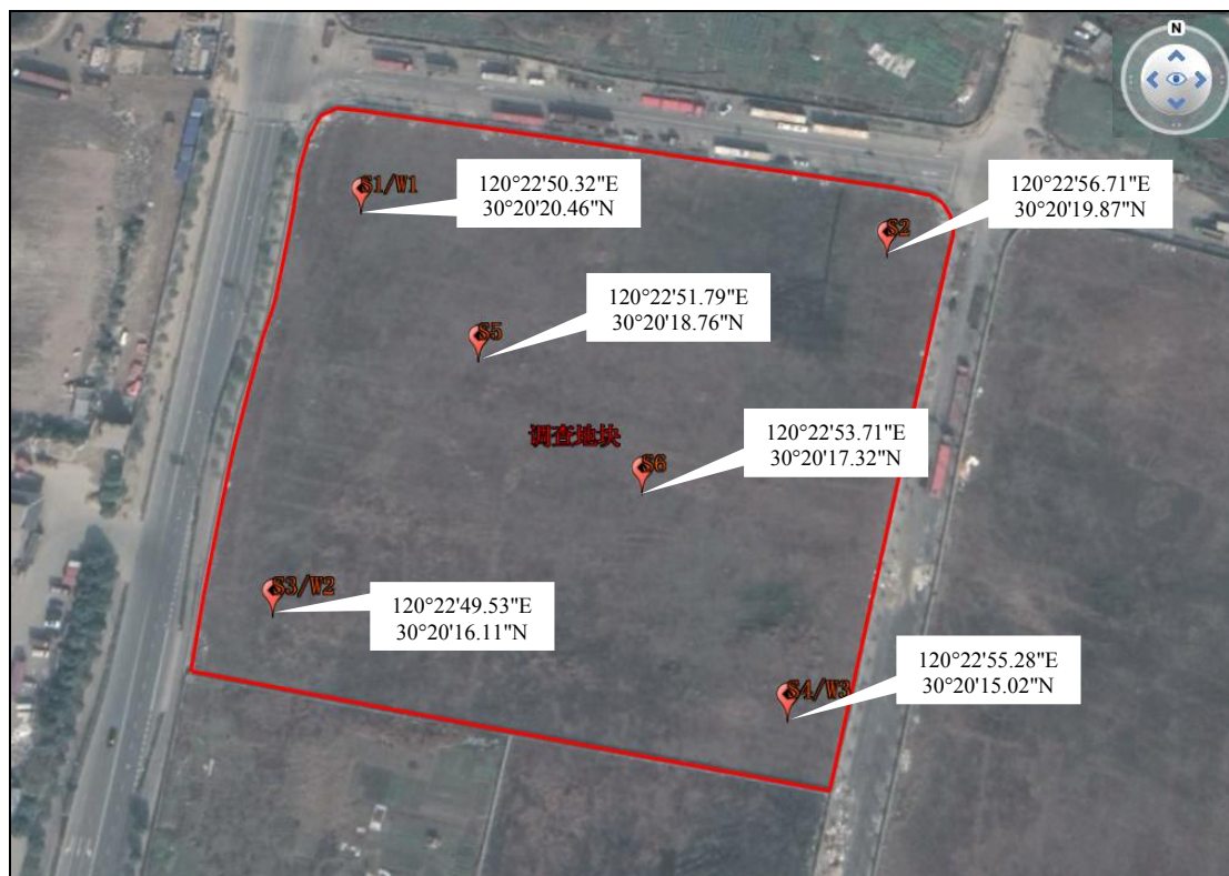
图 4.2-1 本次地块调查土壤及地下水采样点位布设图（内部）
