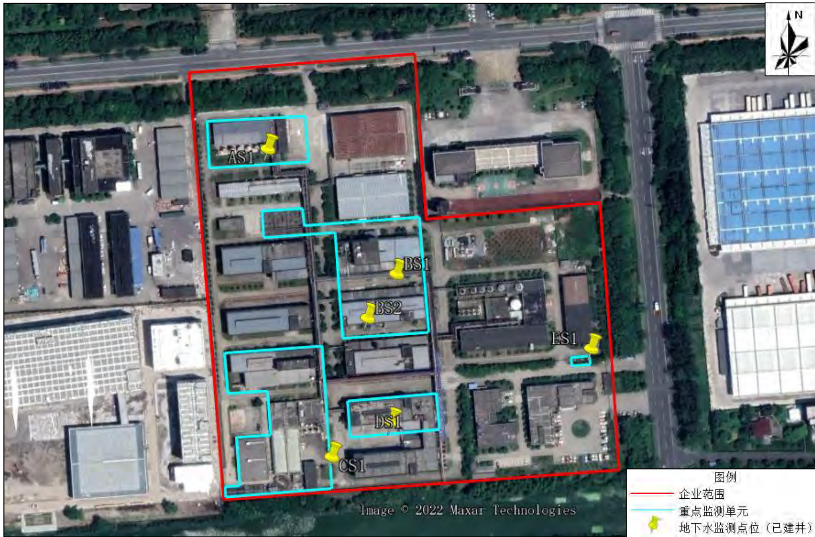
图 6.1-2 企业自行监测地下水监测点位布设图
