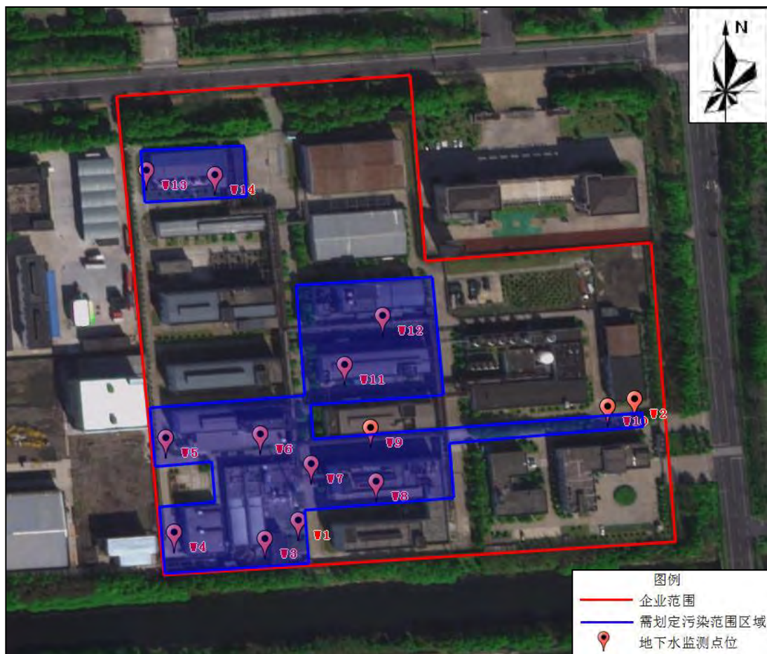
图2.3-3 地下水采样点位图（企业内部）
