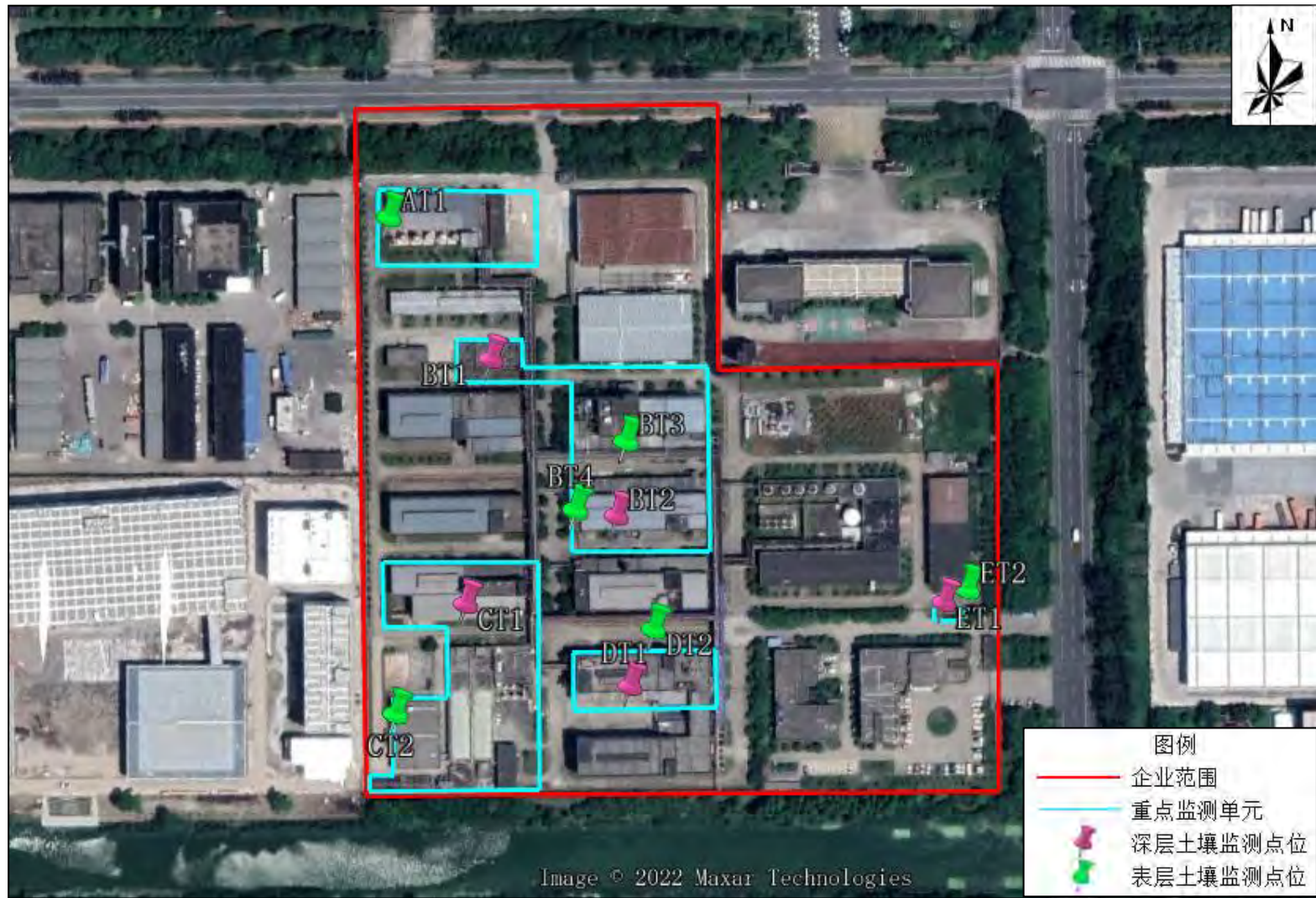
图 6.1-1 企业自行监测土壤监测点位布设图
